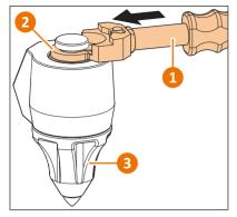
Для резцов со стопорным кольцом требуется молоток и съемный/ установочный инструмент **HammerMaster**.
