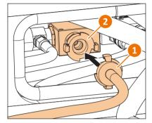
Дополнительная система водораспыления сокращает пылеобразование во время работы.
