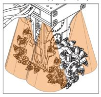
Дополнительно на агрегат можно смонтировать систему водораспыления. Система водораспыления сокращает пылеобразование во время работы. Для этого на нижней части промежуточной консоли расположены отверстия с водяными соплами, которые направляют распылительный конус на режущие головки.
