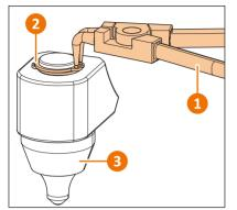
Для резцов с упорными кольцами требуются клещи для наружных упорных колец.
