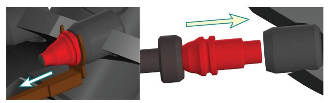
Выдергивание резца специальным инструментом (при невозможности выбивки)
