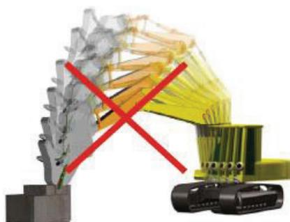
Не использовать агрегат для нанесения ударов и трамбования!
