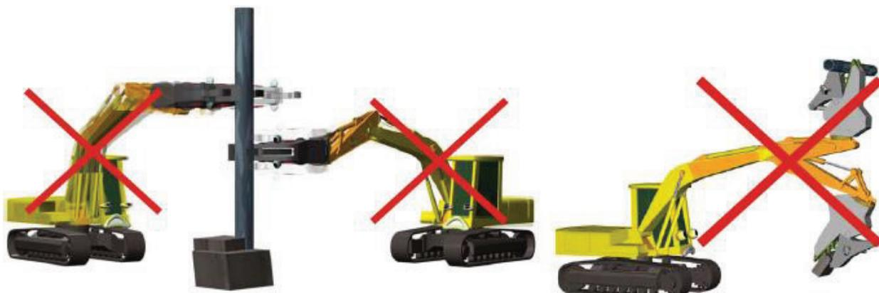
Не прилагать поперечную нагрузку на агрегат!
