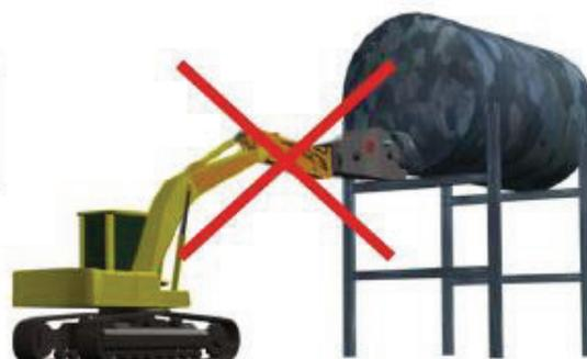
Чрезмерное воздействие врезаящим носком не допускается!
